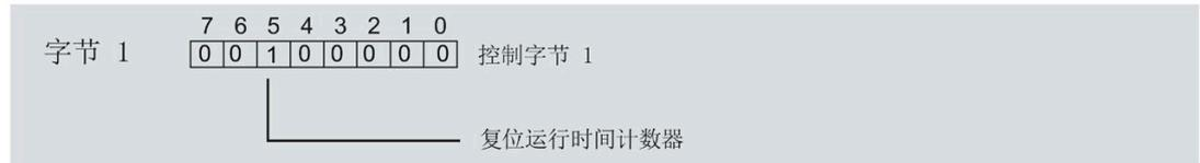
图 8-2 所有运行时间计数器的控制字节 1 复位
